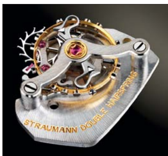
Echappement Straumann Double Hairspring – deux ressorts spiraux de balancier pour compenser l'erreur due à la force de gravité.
